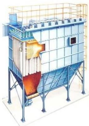
图 5.1-1 袋式除尘器结构示意图
