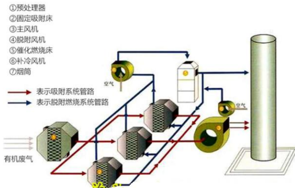
图 5.1-2 活性炭吸附+催化燃烧处理有机废气示意图
